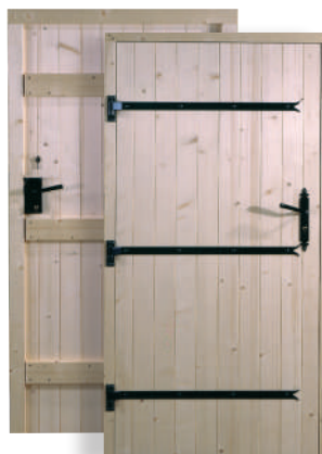
Modèle sapin du Nord, frises verticales pas de 27 mm , dormant 65 x 55 mm, serrure à cylindre 1 point, ouverture extérieure.
