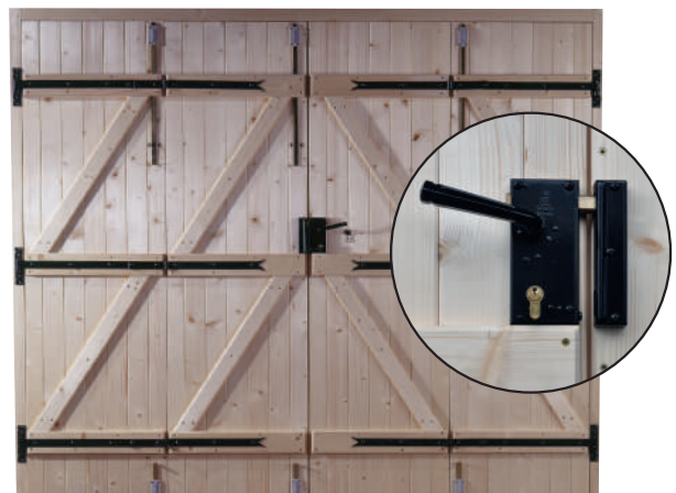
Porte de garage 4 vantaux repliables, serrure 1 point, verrou baïonnette, bâti 65 x 55 mm, avec bâti cintré dessous sans seuil - Sapin du Nord.
